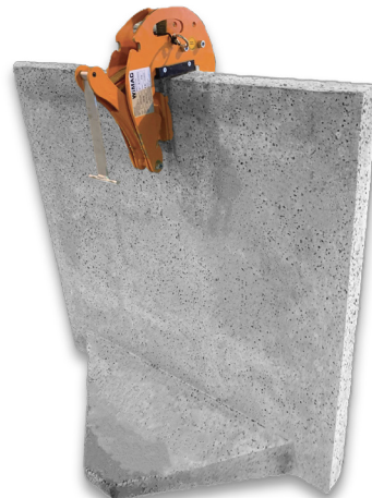
Palonnier de manutention (Consigne/Déconsigne) Épaisseur de serrage de 3 à 11 cm
